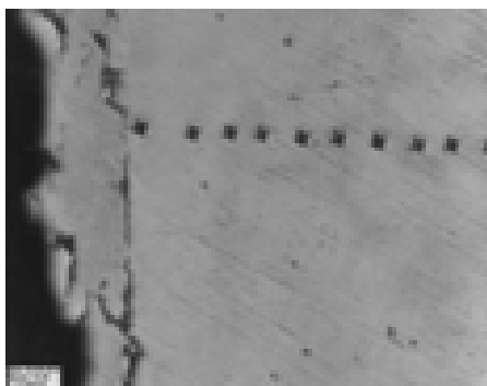
Микроструктура протравленного шлифа стали с электроискровым покрытием сплавом БрКМц Р4-4
